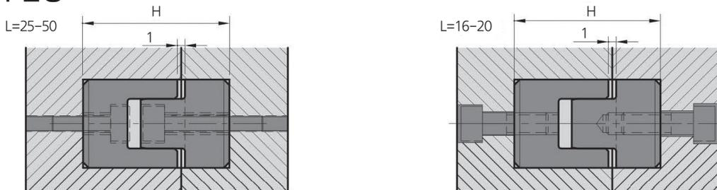
오목한 부분과 튀어나온 부분이 서로 부딪혀 망가지는 것을 피하기 위해 설치 할 때엔 1mm의 틈을 남겨주어야 합니다. 위 그림 참고해주세요.
